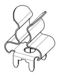
Artikelnummer 36653.1 Länge 8 mm EAN **4251269319** Breite 11,8 mm 273 Höhe 17,5 mm Verpackungsei 25 Aufbauhöhe 14,9 mm nheit Höhe Lötfuss H 4,4 mm Anzahl Pin S 1,6 mm Schirmklamme Pin h 2,6 mm Raster a × b 5 x 7.2 mm Für max. Lochung 1.8 Anzahl Leitungen Min. 3 mm Schirmdurchm. Max. 6 mm Schirmdurchm.
