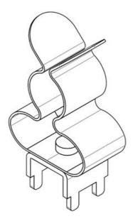
Artikelnummer 37306 Länge 8 mm **4251269333** Breite 11,8 mm EAN 27 mm 279 Höhe 20,2 mm Verpackungsei 10 Aufbauhöhe nheit Höhe Lötfuss H 6,8 mm Anzahl 1 Pin S 1,6 mm Schirmklamme Pin h 2,6 mm 5 x 7.2 mm Raster a  $\times$  b Lochung 1.8 Für max. 1
