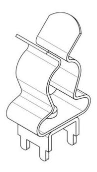
Artikelnummer 36650.4 Länge 8 mm 11,8 mm EAN 4251269334 Breite 283 Höhe 27 mm 20,2 mm Verpackungsei 10 Aufbauhöhe Höhe Lötfuss H 6,8 mm nheit Pin S 1,6 mm Anzahl 2,6 mm Schirmklamme Pin h 5 x 7.2 mm rn Raster a × b Für max. Lochung 1.8 Anzahl
