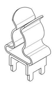
Artikelnummer 36650.3 Länge 8 mm **4251269303** Breite EAN 11,8 mm 142 Höhe 22 mm Verpackungsei 10 Aufbauhöhe 15,2 mm Höhe Lötfuss H 6,8 mm nheit Anzahl Pin S 1,6 mm Schirmklamme Pin h 2,6 mm Raster a × b 5 x 7.2 mm rn Für max. Lochung 1.8
